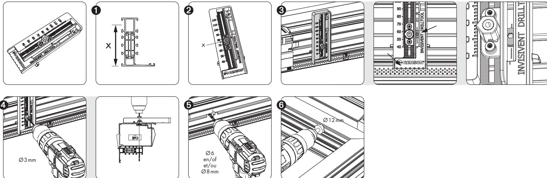
Um Invisivent AIR/COMFORT nach oben zu verankern, können Sie den Invisivent PVC-Körper mit Hilfe der Bohrlehre von Renson durchschrauben.
