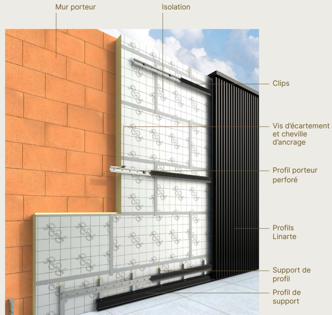
La fixation brevetée permet de fixer les profils porteurs directement sur la construction sous-jacente. Comparé au système classique avec une structure porteuse en bois, cette méthode est plus avantageuse du fait du faible coût des matériaux et de l'installation plus rapide. Grâce à la fixation directe, il y a moins de ruptures de pont thermique, l'épaisseur totale du système est plus petite et vous obtenez une solution durable.
