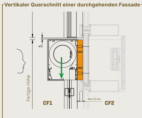
Die Blickrichtung bestimmt die Auswahlmöglichkeit Kabeldurchführung links oder rechts Richtung der Entnahme der Tuchwelle
