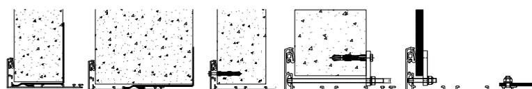
Befestigung Maueranker Position 1
