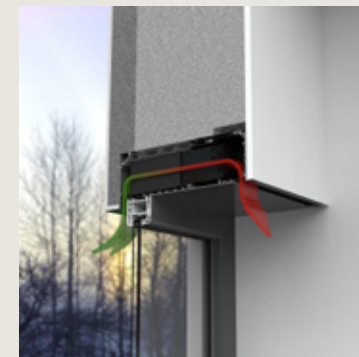
Pulsion vers le bas + profil de plâtre
