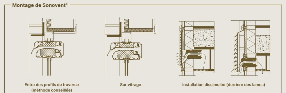
Il n'est pas recommandé de monter un Sonovent dans un châssis ouvrant de la fenêtre.
