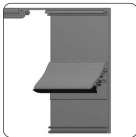
Bij breedtes van 4 m tot 6 m, wordt nu ook steeds gebruik gemaakt van het doekgeleidingsprofiel zoals dit al toegepast werd bij de Detecto motoren.
