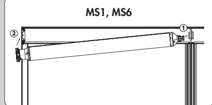
Bij een koppelzijgeleider past men eerst de doekrol in het koppelstuk ①. Daarna schuift u de doekrol in het inzetstuk ② en bevestigt u de kunststof schuif tegen de zijconsoles. Plaats eerst het gedeelte waar de motor in zit; nadien het gedeelte van de lager (voor veiliger montage). Ondersteun hierbij de onderlat. Dankzij de Connect&Go-technologie verloopt dit vlot.
