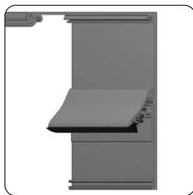
Pour des largeurs de 4 à 6 m, on utilisera maintenant toujours le profil de guidage, comme c'était déjà le cas avec les moteurs Detecto.
