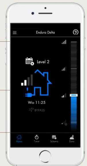
Contrôle du fonctionnement du système de ventilation Vous obtenez ainsi des informations sur le débit total, l'humidité relative mesurée, la qualité de l'air intérieur mesurée, la température intérieure et extérieure et l'état du filtre.
