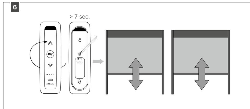
Appuyez plus de 7 sec. sur la touche PROG à l'arrière de l'émetteur Situo 1 io jusqu'à ce que le Fixscreen effectue 2 X un bref mouvement de va-et-vient.
