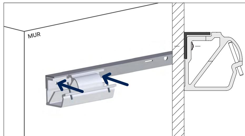
Utilisez des vis en fonction de la construction sous-jacente (à fournir par l'installateur).
