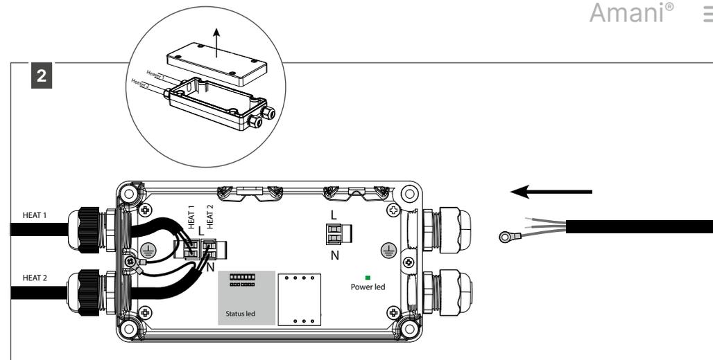
Déposez d'abord le capot transparent du récepteur et faites passer le câble d'alimentation par le presse-étoupe ouvert jusqu'au récepteur.
