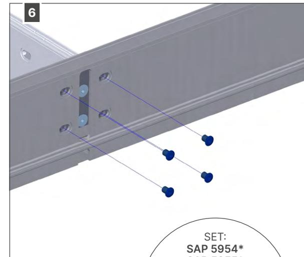
\* SAP 5954: couteau de connexion pivot - SAP 5955: couteau de connexion span
