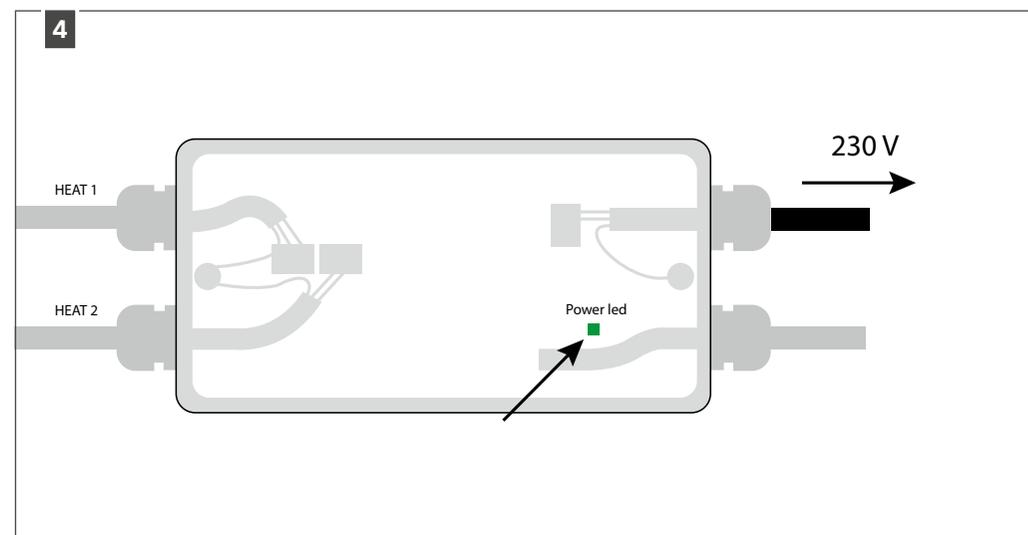
Connectez ensuite le câble d'alimentation sur le réseau électrique (230 V AC). La LED d'alimentation du récepteur doit s'allumer en vert. Cela signifie que le récepteur reçoit effectivement une tension.
