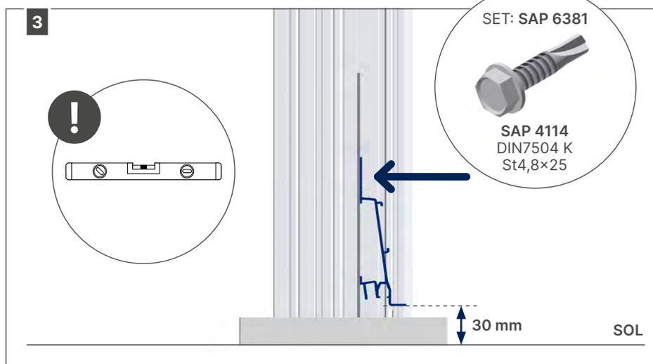
Le profil de support doit être de niveau. Si la pente est inclinée, le profil de support doit pendre à au moins 30 mm du sol.
