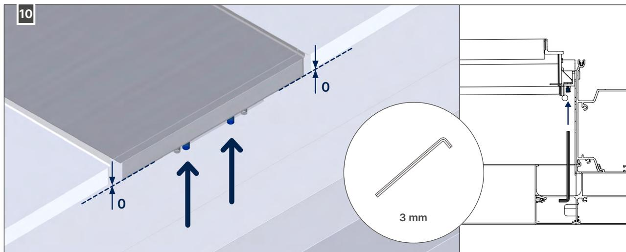
Vue depuis le côté inférieur de la lame Lineo Fix avec alignement entre deux lames standards
