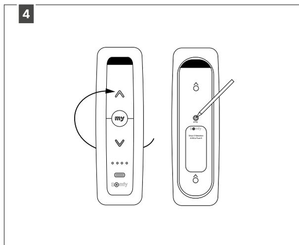
Appuyer brièvement sur le bouton PROG à l'arrière de l'émetteur Situio io pour confirmer le réglage.
