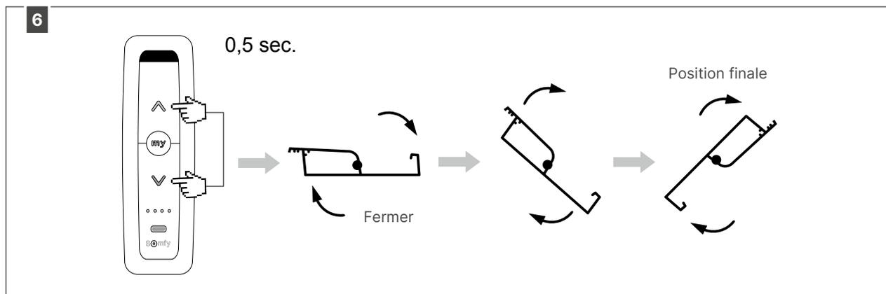
Appuyez simultanément (brièvement) sur la touche UP et DOWN de la commande, les lames vont d'abord se fermer entièrement et ensuite s'ouvrir complètement de manière automatique. (fins de course).
