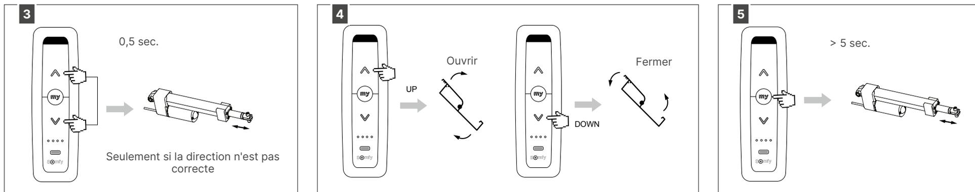
Appuyez simultanément (brièvement) sur la touche UP et DOWN de la commande. L'entraînement du moteur effectue un bref mouvement de va-et-vient en guise de confirmation.
