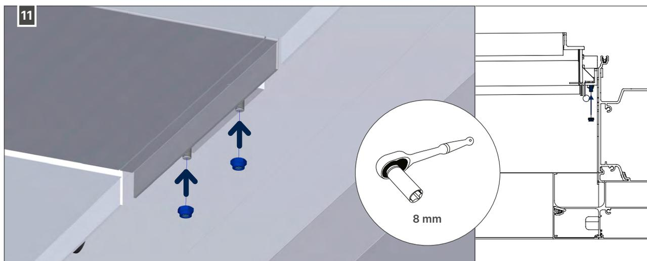
Vue depuis le côté inférieur de la lame Lineo Fix
