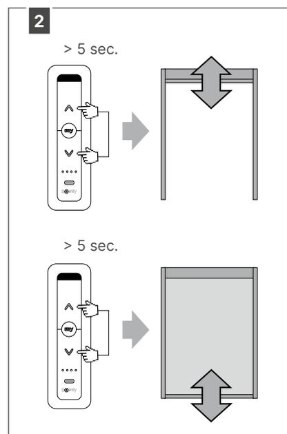
Appuyez simultanément plus de 5 sec. Sur la touche UP et DOWN jusqu'à ce que le Fixscreen effectue un bref mouvement de va-et-vient.
