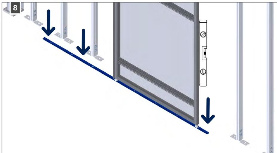
Fixez le rail inférieur. Utilisez du matériel de fixation adapté au support, p. ex. DIN 7982 CH - ST4,2×13 (non fourni).
