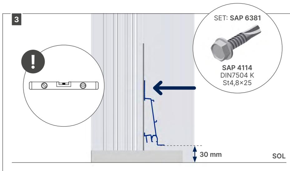
Le profil de support doit être de niveau. Si la pente est inclinée, le profil de support doit pendre à au moins 30 mm du sol.
