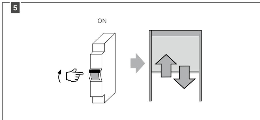
Branchez l'alimentation 230 V. Le Fixscreen effectue un mouvement de 3 sec. dans la direction opposée du dernier mouvement, si le Fixscreen se trouve entre les deux fins de course. Si le Fixscreen est sur une fin de course, il effectue un bref mouvement de va-et-vient.
