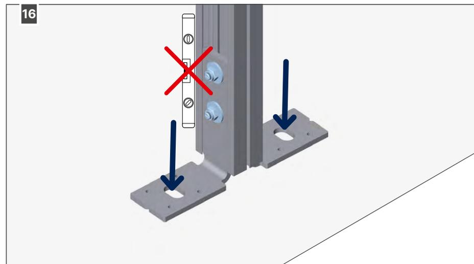
Fixez les poteaux. À cette fin, utilisez le matériel de fixation adapté au support (à prévoir par l'installateur).
