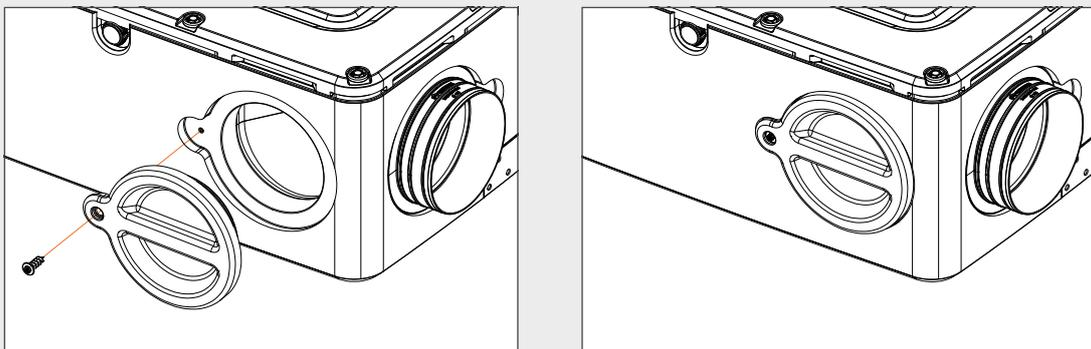
Après l'installation, tous les éléments susceptibles de provoquer des blessures se trouvent en sécurité à l'intérieur du boîtier. Des outils sont indispensables pour ouvrir le boîtier.
