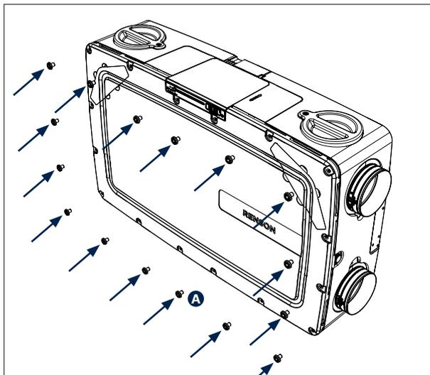
Desserrez les 16 vis en plastique (A) avant de retirer le capot.
