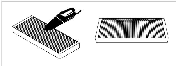
4. Assurez-vous que les filtres sont correctement positionnés, puis remettez les capots de filtre en place. Le filtre à charnière breveté, une innovation de Renson, empêche de placer les filtres dans le mauvais sens.
