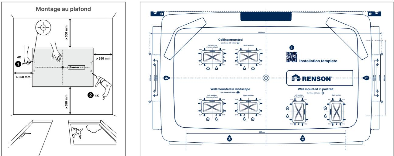
Montage au plafond avec QuickFix – Position dans la pièce (unité en mm) – Configuration des trous de l'équerre QuickFix.
