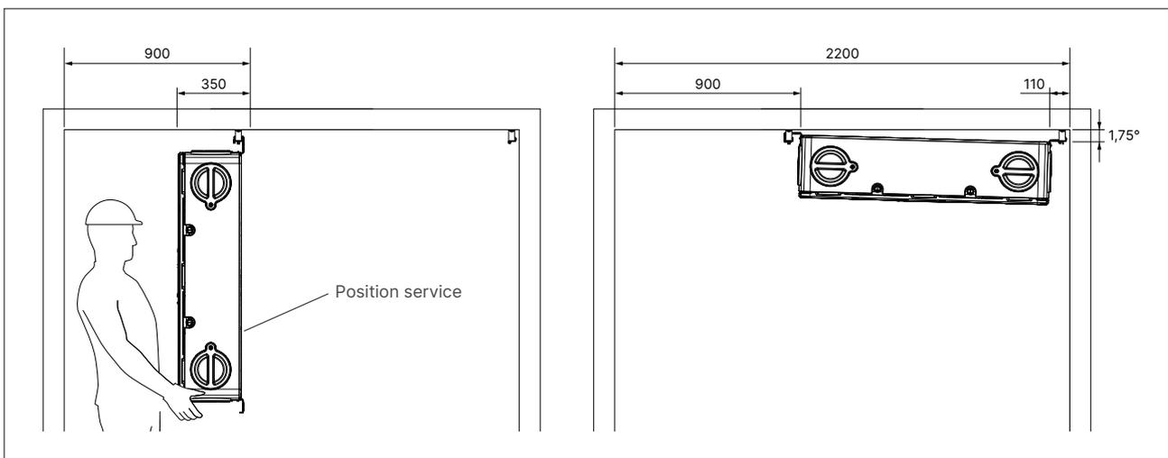
Montage au plafond avec QuickFix – Dégagement d'au moins 900 mm afin d'assurer une accessibilité optimale lors de l'entretien (unité en mm).
