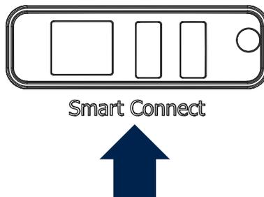
Le dongle wifi de Renson doit être branché sur un port USB de la zone Smart Connect du Renson Flux Go Flat. Le dongle Wifi permet alors de connecter l'unité Flux Go Flat de Renson à :
