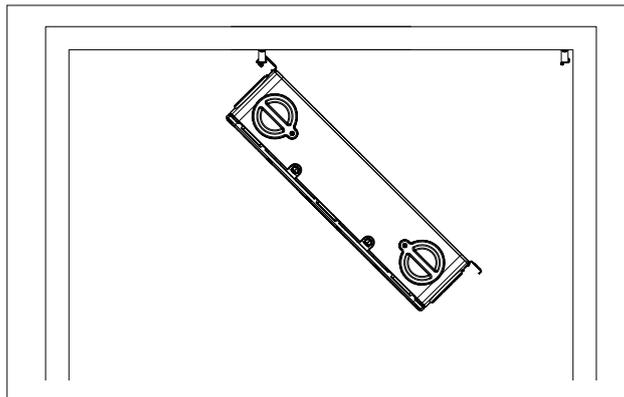
9. Assurez-vous que l'appareil est solidement fixé en serrant les boulons 3xM6 à rondelle éventail et rondelle plate fournis aux endroits indiqués (voir illustration).
