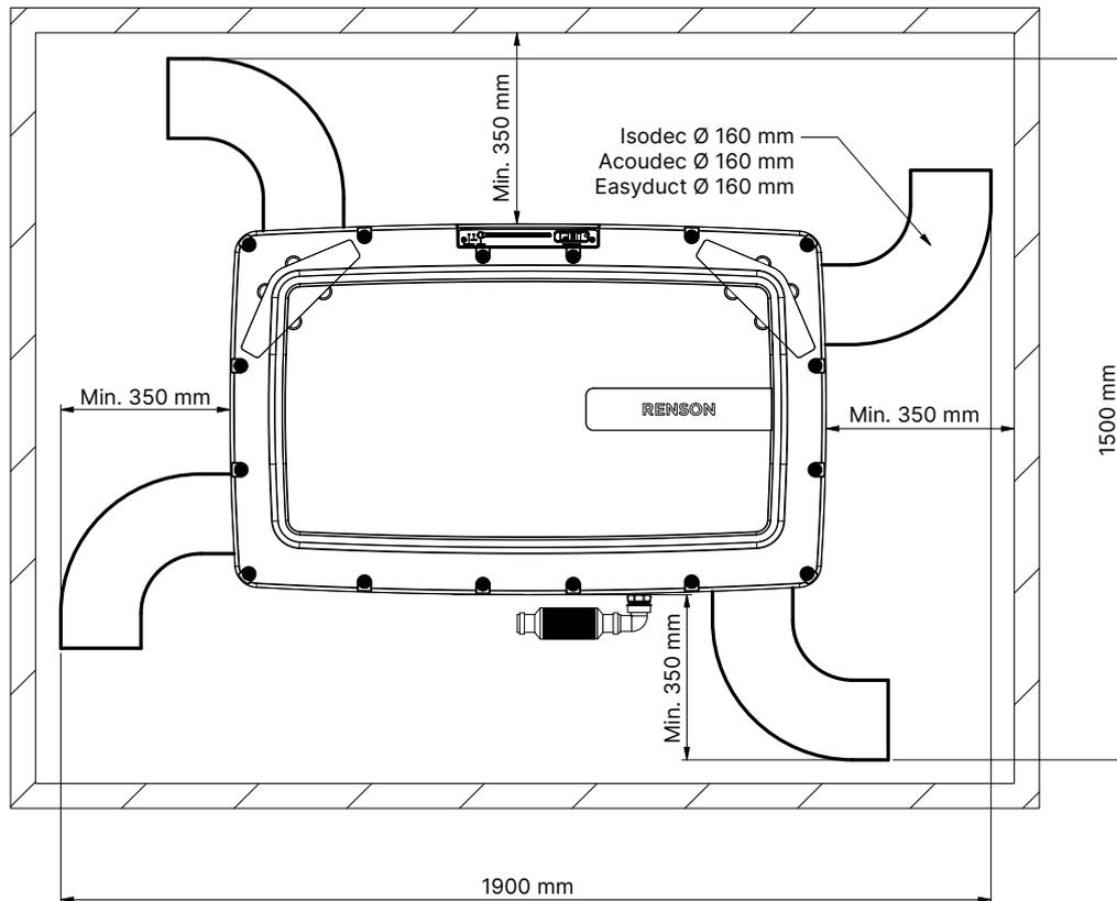
Vous trouverez ci-dessous quelques exemples d'installations réelles, qui tiennent compte des distances minimales mentionnées ci-dessus et de la recommandation de Renson de toujours prévoir 1 m d'Acoudec Ø 160 mm du côté de l'impulsion et de l'extraction. Cela garantit une installation silencieuse !
