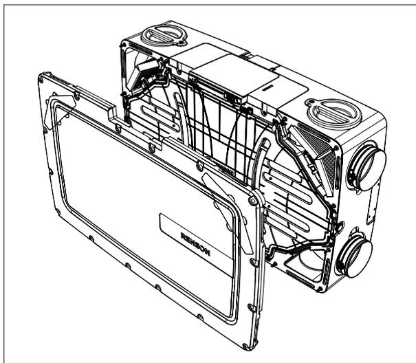
3. Dévissez d'un tour les languettes (B) du bac de récupération du condensat (C), puis tournez les languettes d'un quart de tour.
