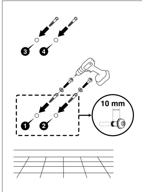
Montage mural vertical (avec vis et chevilles) – au moins 1 cm de distance entre le mur et la tête du boulon pour l'accrochage de l'appareil.
