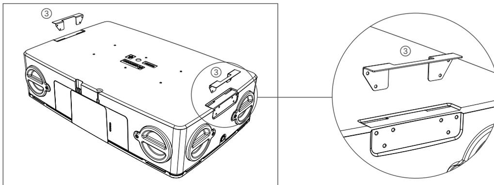
3. Montez les équerres de suspension aux extrémités, en suivant la configuration des trous sur le côté. Les équerres de suspension sont identifiées par un arbre et une maison, qui correspondent respectivement au raccordement extérieur RExt (🌳) et au raccordement domestique RD (🏠).
