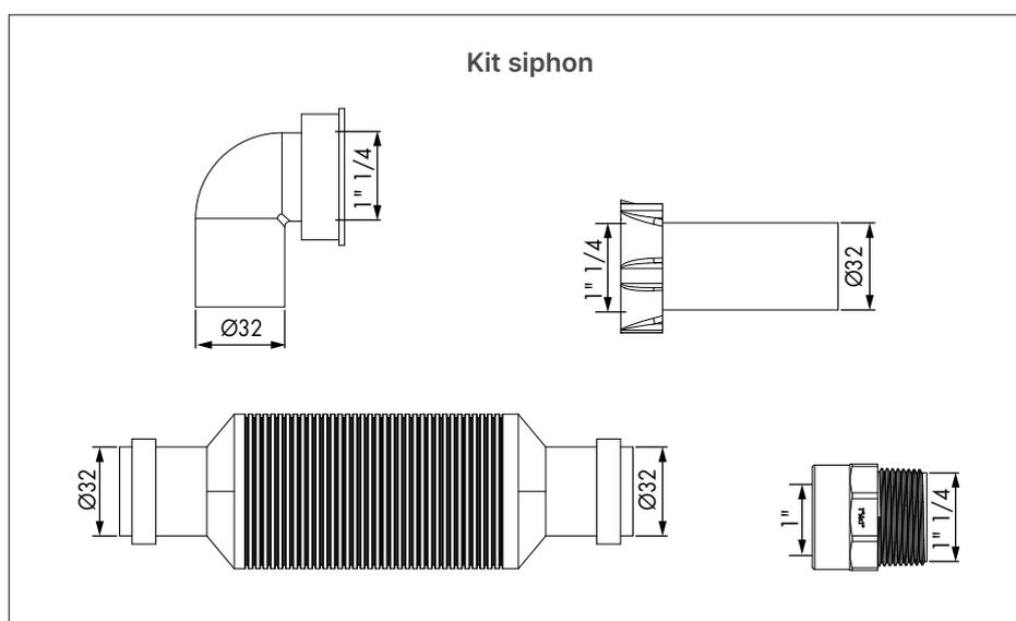
Pour une bonne évacuation d'eau sans mauvaises odeurs, il est fortement recommandé d'utiliser le kit siphon pour Flux Go Flat de Renson. Suivez scrupuleusement les instructions de la fiche fournie pour garantir le bon fonctionnement de l'appareil.
