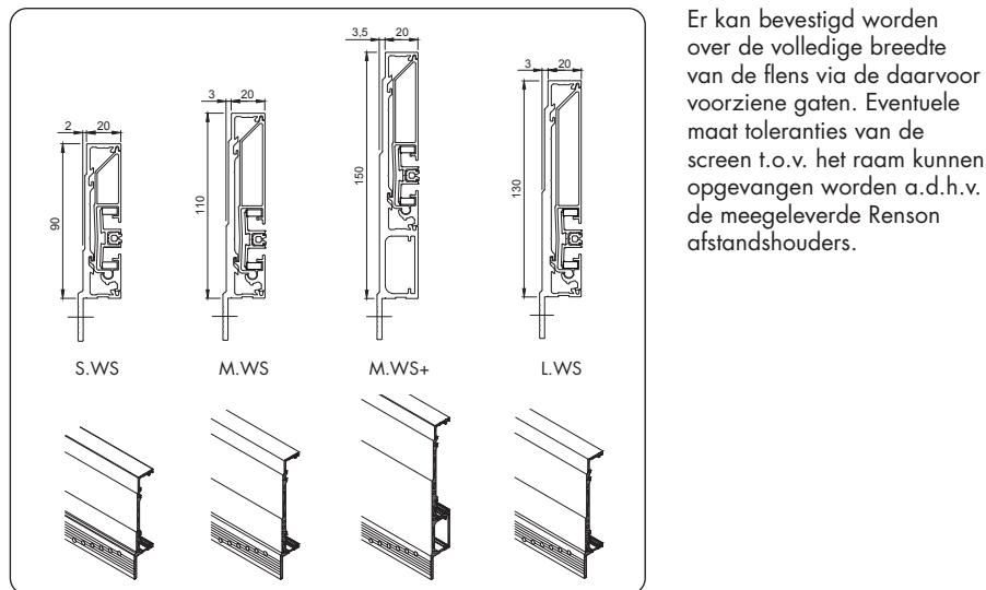
Er kan bevestigd worden over de volledige breedte van de flens via de daarvoor voorziene gaten. Eventuele maat toleranies van de screen t.o.v. het raam kunnen opgevangen worden a.d.h.v. de meegeleverde Renson afstandshouders.
