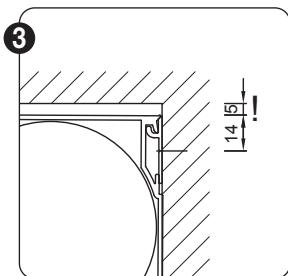
Positioneer het inhaakprofiel zodat er voldoende ruimte is om de kast nog te kunnen inhaken. Hou rekening met een extra hoogte van 5 mm om vlot te kunnen inhaken.
