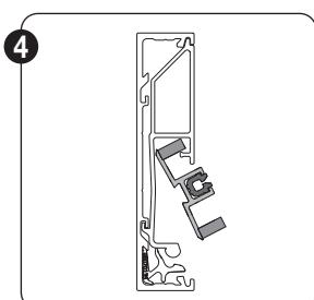
Introduisez le guide pour fermeture éclair en aluminium dans le profil intermédiaire en le tournant et assurez-vous que le caoutchouc cellulaire soit bien positionné.
