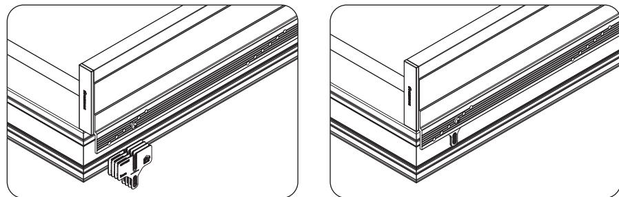
Faites glisser les plaques de remplissage sur la vis, entre le cadre de la fenêtre et la coulisse. Faites-le pour les deux vis. Vérifiez l'équerrage et l'alignement du store par rapport au cadre de la fenêtre. Si le nombre des plaques de remplissage est suffisant, les vis restantes peuvent être appliquées, en utilisant la même quantité. Ensuite, serrez également les vis supérieures et inférieures.
