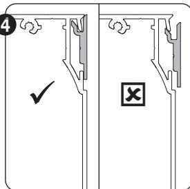
Verzeker dat bij het op-hangen van de kast, deze weldeegelijk correctinhaakt in het inhaakprofiel.
