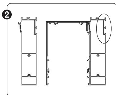
Ensuite, le caisson s'accroche sur le crochet prévu à cet effet. Prévoyez une hauteur supplémentaire de 10 mm du caisson de base M.W+ par rapport au caisson. Pour éviter tout fléchissement du caisson de base M.W+ au milieu, il faut le fixer en plus au milieu pour les systèmes > 3600 mm. Il peut s'agir d'une fixation au cadre par l'intermédiaire de l'équerre de fixation de Renson (voir section 3.3.3) ou directement à la structure.
