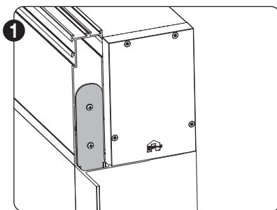
Pour garantir que le caisson de base M.W+ et le profil fixe de la coulisse M.WF+/M.WS+ soient parfaitement alignés l'un par rapport à l'autre, un support est fourni.
