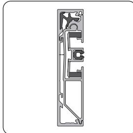
Utilisez des vis avec une tête de hauteur maximale de 2,5 mm pour que la coulisse puisse se cliquer sans problème.
