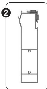
Om ervoor te zorgen dat de basis kastprofielen M.W+ onderling perfect gedigneerd zijn wordt een uitlijnblokje ingebracht bij het start en tussen profiel.
