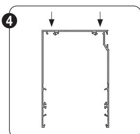
④ Le caisson peut maintenant être fixé. Faites ceci sur les lignes de perçage prévues à cet effet afin que la tête de la vis ne puisse jamais atteindre la toile. Prévoyez une fixation près des consoles, de même qu'au milieu du profil du caisson.
