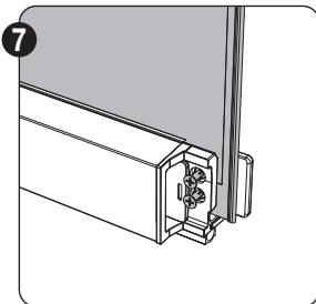
Positionnez la toile correctement dans l'embout de la barre de charge. Veillez à ce que la toile soit positionnée bien plate entre les embouts de la barre de charge.
