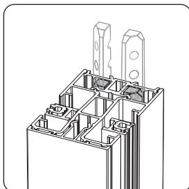
Des goujons de montage sont préassemblés dans la coulisse de couplage. Ils peuvent être rétractés jusqu'à ce que le caisson soit monté sur la coulisse.
