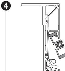
4 Draai het aluminium ritsgeleiderprofiel in het tussenprofiel en verzekert dat de mousse zich goed positioneert.
