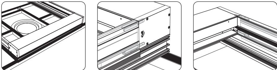
Bepaal vooraf de correcte positie van de geleider op het raamkader aan de hand van een correcte uitlijning met de kast. Presenteer hiervoor de geleiders samen met de kast op het raamkader.
