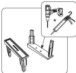
Deze diepe geleiders zijn voorzien van een aluminium voetplaat onder  $0^\circ$  of  $5^\circ$ . De voetplaten onder  $5^\circ$  zijn uitgerust met holte onderaan; welke met silicone opgespoten kan worden voor een extra waterdichting richting de spouw. Hiervoor zijn boorpunten voorzien, waarlangs na doorboring de silicone kan ingespoten worden.
