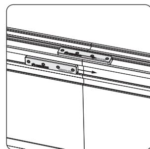
Afin d'assurer un alignement parfait des caissons de base M.W+, un bloc d'alignement est inséré au niveau des profils de départ et intermédiaires.
