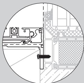
• Coulisses profondes M.WS/M.WS+ pour un montage latéral sur le cadre de la fenêtre
