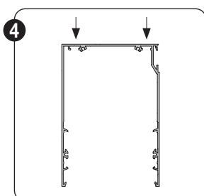
Le caisson peut maintenant être fixé. Faites ceci sur les lignes de perçage prévues à cet effet afin que la tête de la vis ne puisse jamais atteindre la toile. Prévoyez une fixation près des consoles, de même qu'au milieu du profil du caisson.
