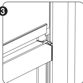
Pour cliquer la barre de charge à la toile, commencez de préférence par un côté (droit ou gauche). Veillez au départ à ce que le profil clips soit bien situé contre l'embout en PVC, et que l'extrémité de la fermeture éclair couisse au ras de l'embout en PVC. Y visser la barre de charge.
