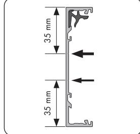
Er zijn twee zichtbare markeringen aangebracht op 35 mm waar u probleemloos kan bevestigen. Bevestig indien mogelijk aan de raamzijde waar ook de clipsen zich bevinden.
