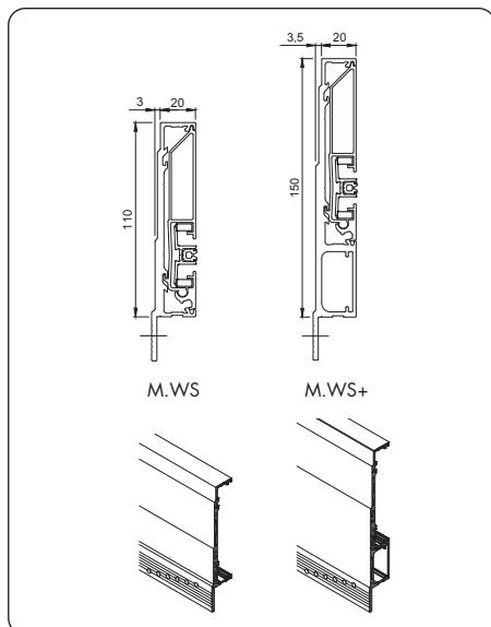
Er kan bevestigd worden over de volledige breedte van de flens via de daarvoor voorziene gaten. Eventuele maat toleranties van de screen t.o.v. het raam kunnen opgevangen worden a.d.h.v. de meegeleverde Renson afstandshouder.
