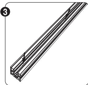
Bevestig beide profielen vervolgens aan elkaar. Er zijn Schroefgaten voorzien om de 250 mm, voorzie zeker een bevestiging om de 500 mm. Per koppelzijgeleider is een zakje met schroeven voorzien.
