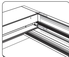
Bepaal vooraf de correcte positie van de geleider op het raamkader aan de hand van een correcte uitlijning met de kast. Presenteer hiervoor de geleiders samen met de kast op het raamkader.
