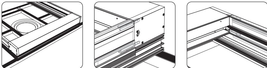
Déterminez à l'avance la position correcte de la coulisse sur le cadre de la fenêtre, en fonction de l'alignement correct avec le caisson. Pour ce faire, présentez les coulisses avec le caisson sur le cadre de la fenêtre.
