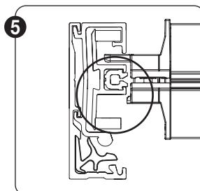
Si la barre de charge est déjà préassemblée, veillez à ce que les tiges de la barre de charge soient bien positionnées par rapport au guide pour fermeture éclair en aluminium. Pour faciliter le travail, ouvrir la tige sur le devant de la barre de charge.
