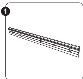
Le profil d'accrochage a une longueur de 300 mm et peut être fixé à la construction sous-jacente.
