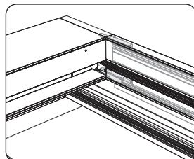
Déterminez à l'avance la position correcte de la coulisse sur le cadre de la fenêtre, en fonction de l'alignement correct avec le caisson. Pour ce faire, présentez les coulisses avec le caisson sur le cadre de la fenêtre.
