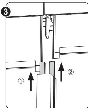
Faites glisser la fermeture éclair du store le plus bas dans le guide de fermeture éclair en aluminium de la coulisse C.F ①. Faites ensuite de même avec l'autre store ②.
