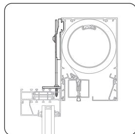
Plaats en bevestig het koppelstuk in de groef op de kast of de basis kast M.W+. Bevestig de beugel aan het koppelstuk met de bijgeleverde bouten. Bevestig nadien de beugel aan het raam. De positie van de kast tot het raam kan naar eigen voorkeur bepaald worden door de bouten los te draaien en de kast te herpositioneren.
