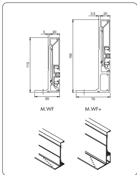
La coulisse peut être fixée sur toute la largeur de la bride via les trous prévus à cet effet. Cette bride peut, mais ne doit pas nécessairement, être alignée avec le cadre de la fenêtre. Un alignement correct avec le caisson, en utilisant les goujons de montage, détermine le bon positionnement de la coulisse et par conséquent la position de la vis.
