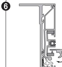
Positionner le profil de fermeture perpendiculairement ( $90^\circ$ ) dans la coulisse et le fermer en exerçant une pression sur les clips bleus ou noirs. L'angle de  $90^\circ$  permet à la mousse de rester joliment droite.
