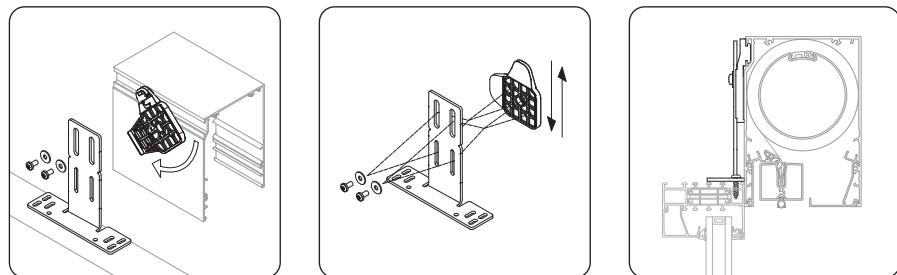
Placez et fixez la pièce de couplage dans la rainure du caisson ou du caisson de base M.W+ du Fixscreen® Minimal. Fixez le support à la pièce d'accouplement à l'aide des boulons fournis. Fixez l'équerre à la fenêtre. La position du caisson par rapport à la fenêtre peut être ajustée à volonté en desserrant les boulons et en repositionnant le caisson.
