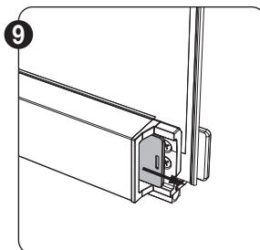
Fermez la tige de la barre de charge, celle-ci va se positionner devant les vis.
