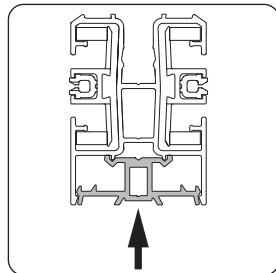
Klik het tussenprofiel los van het vast profiel van de koppelzijgeleider.
