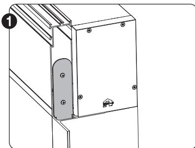
Om ervoor te zorgen dat het basis kastprofiel M.W+ en het vast profiel van de zijgeleider M.WF+/M.WS+ perfect t.o.v. elkaar gealigneerd zijn, is een beugel voorzien.
