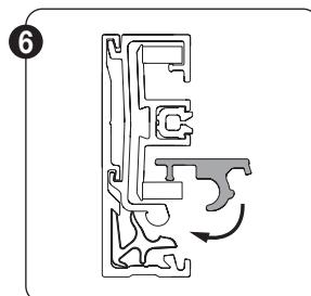
Positionner le profil de fermeture perpendiculairement ( $90^\circ$ ) dans la coulisse et le fermer en exerçant une pression sur les clips bleus ou noirs. L'angle de  $90^\circ$  permet à la mousse de rester joliment droite.
