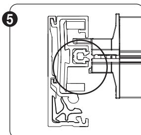
Indien de onderlat reeds voorgeassembleerd is, zorgt u ervoor dat de vinger van de onderlat zich correct positioneert ten opzichte van het aluminium ritsgeleiderprofiel. Om eenvoudig te werken schuift u de vinger aan de voorzijde van de onderlat open.
