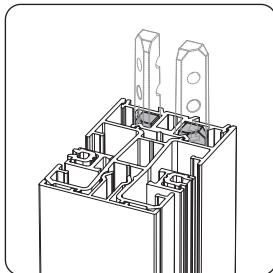
In de koppelzijgeleider zitten montagestiften voorgeassembleerd. Deze mogen ingetrokken blijven tot wanneer de kast op de geleider geplaatst wordt.
