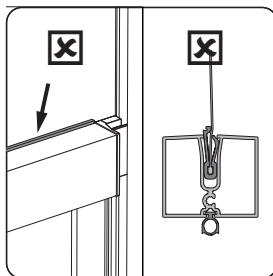
Positionnez la toile correctement dans l'embout de la barre de charge. Veillez à ce que la toile soit positionnée bien plate entre les embouts de la barre de charge.
