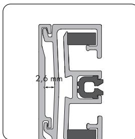
Utilisez des vis avec une tête de hauteur maximale de 2,5 mm pour que la coulisse puisse se cliquer sans problème.
