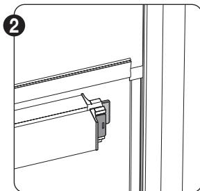
Tenez la barre de charge correctement. La tige fixe de la barre de charge se trouve du côté de la fenêtre, la tige mobile reste donc entièrement accessible.
