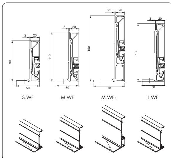
La coulisse peut être fixée sur toute la largeur de la bride via les trous prévus à cet effet. Cette bride peut, mais ne doit pas nécessairement, être alignée avec le cadre de la fenêtre. Un alignement correct avec le caisson, en utilisant les goujons de montage, détermine le bon positionnement de la coulisse et par conséquent la position de la vis.
