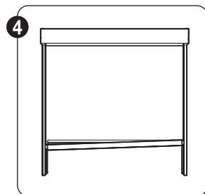
Duw het clipsprofiel in de onderlat. Druk hierbij zowel achter als voor het doek op het clipsprofiel.
