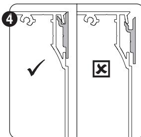
Verzeker dat bij het ophangen van de kast, deze weldegelijk correct inhaakt in het inhaakprofiel.
