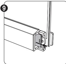
Sluit de vinger van de onderlatprop, deze positioneert zich voor de schroeven.
