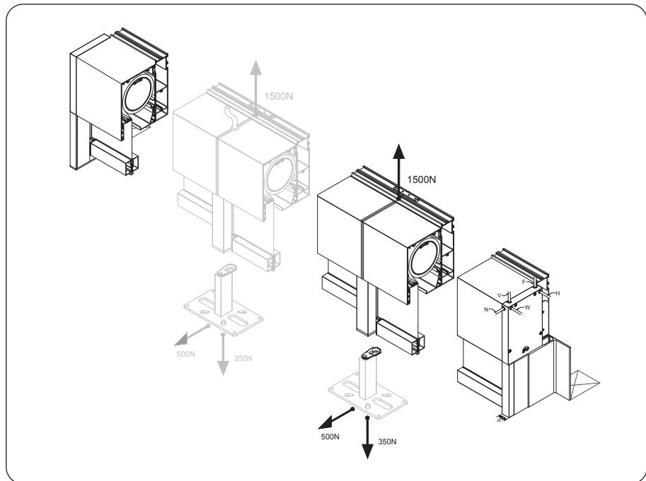
De kast moet geborgd worden aan de achterliggende constructie of het raamkader. De kasten moeten zodanig geborgd worden dat deze autonoom blijven hangen. Maximale totale te dragen kracht is 1500 N.
