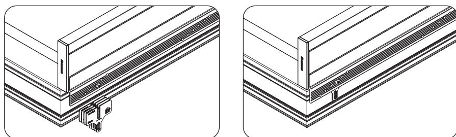
Faites glisser les plaques de remplissage sur la vis, entre le cadre de la fenêtre et la coulisse. Faites-le pour les deux vis. Vérifiez l'équerrage et l'alignement du store par rapport au cadre de la fenêtre. Si le nombre des plaques de remplissage est suffisant, les vis restantes peuvent être appliquées, en utilisant la même quantité. Ensuite, serrez également les vis supérieures et inférieures.
