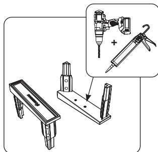
Ces coulisses profondes sont équipées d'une plaque de base en aluminium à 0° ou 5°. Les plaques de base à 5° sont équipées d'une cavité au fond qui peut être injectée de silicone pour une étanchéité supplémentaire vers la cavité. Des points de perçage sont prévus à cet effet, le long desquels le silicone peut être injecté après le perçage.
