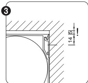
Positioneer het inhaakprofiel zodat er voldoende ruimte is om de kast nog te kunnen inhaken. Hou rekening met een extra hoogte van 5 mm om de kast vlot te kunnen inhaken.
