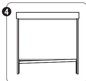
Poussez le profil clips dans la barre de charge. Pour cela, poussez la toile sur le profil clips à l'arrière comme à l'avant.
