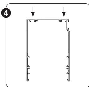
De kast kan nu geborgd worden. Hou er rekening mee dit te doen op de daarvoor voorziene boorlijnen zodat het doek de schroefkop nooit kan raken. Voorzie een borging dicht bij de zijconsoles alsook in het midden van het kastprofiel.
