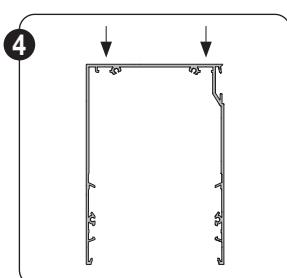
De kast kan nu geborgd worden. Hou er rekening mee dit te doen op de daarvoor voorziene boorlijnen zodat het doek de Schroefkop nooit kan raken. Voorzie een borging dicht bij de zijconsoles alsook in het midden van het kastprofiel.
