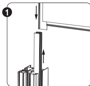
Glissez la toile dans le guide pour fermeture éclair en aluminium. Il est plus simple pour cela de faire coulisser le guide en partie hors du profil intermédiaire.
