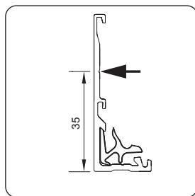
Voor zijdelingse montage is er een markering op 35 mm zichtbaar waar u probleemloos kan bevestigen.
