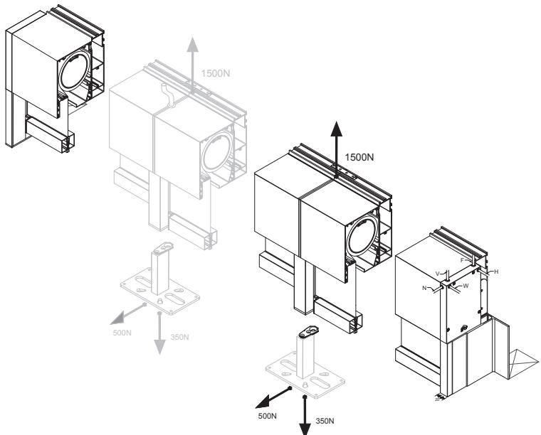
Le caisson doit être fixé à la construction sous-jacente ou le cadre de la fenêtre. Les caissons doivent être fixés de manière à ce qu'ils restent suspendus indépendamment. La force totale maximale à supporter est de 1500 N.
