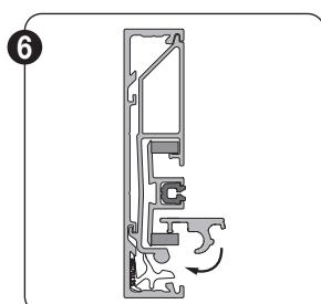
Positionner le profil de fermeture perpendiculairement (90°) dans la coulisse et le fermer en exerçant une pression sur les clips bleus ou noirs. L'angle de 90° permet à la mousse de rester joliment droite.
