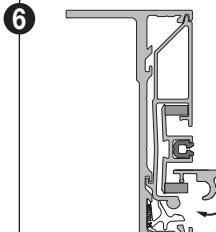
6 Positioneer het sluitprofiel loodrecht ( $90^\circ$ ) in de zijgeleider en klik deze dicht door druk uit te oefenen ter hoogte van de blauwe of zwarte clips. Deze hoek van  $90^\circ$  zorgt dat de mousse hierbij mooi recht blijft zitten.
