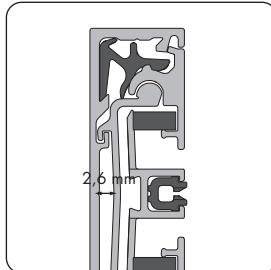
Gebruik schroeven met een maximale kophoogte van 2,5 mm om ervoor te zorgen dat de zijgeleider probleemloos zal toeklikken.
