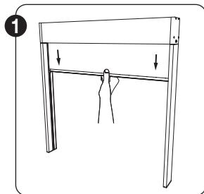
Raccordez le moteur à l'alimentation. Faites dérouler la toile jusqu'à une hauteur accessible pour travailler.
