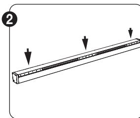
Het inhaakprofiel heeft een lengte van 300 mm en kan bevestigd worden aan de achterliggende constructie.
