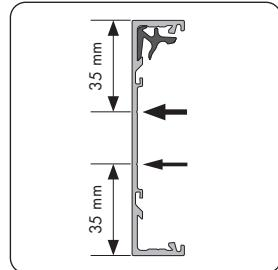
Il y a deux marques visibles à 35 mm où vous pouvez facilement les fixer. Si possible, fixez-les du côté de la fenêtre où se trouvent les clips.
