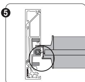
Si la barre de charge est déjà préassemblée, veillez à ce que les tiges de la barre de charge soient bien positionnées par rapport au guide pour fermeture éclair en aluminium.
