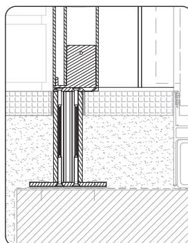
Diverses fentes sont prévues au bas du pied de montage pour la fixation au sous-sol. Les fentes sont plus grandes que le diamètre du boulon, de sorte que cette plaque puisse être déplacée/alignée. Cette plaque peut être fixée au moyen d'une rondelle et d'un écrou. Le modèle à l'échelle 1:1 se trouve à la fin de ce manuel de montage.
