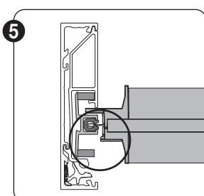
Indien de onderlat reeds voorgeassembleerd is, zorgt u ervoor dat de vinger van de onderlat zich correct positioneert ten opzichte van het aluminium ritsgeleiderprofiel.
