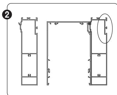
Hierna haakt de kast over de daarvoor voorziene haak. Hou rekening met een extra 10 mm hoogte van het basis kastprofiel ten opzichte van de kast. Om de doorbuiging van het basis kastprofiel M.W+ in het midden tegen te gaan, dient deze bij systemen > 3600 mm in het midden extra geborgd te worden. Dit kan naar het raamkader via de bevestigingsbeugel (zie punt 3.3.3) of rechtstreeks naar de structuur.
