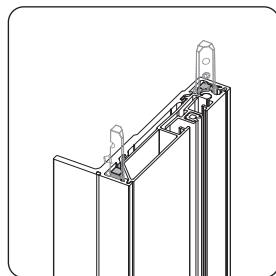
Les goujons de montage sont déjà préassemblés dans la coulisse. Il peuvent rester en position jusqu'à ce que le caisson et la coulisse soient vissés l'un à l'autre.
