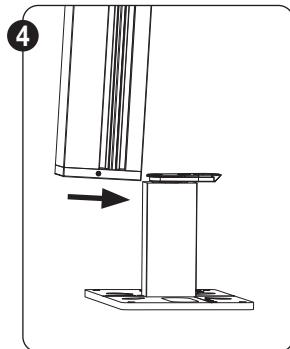
Faites glisser la plaque de base de la coulisse C.F sur la plaque de montage, soit directement ou indirectement sur la structure sous-jacente, soit sur le pied de montage.
