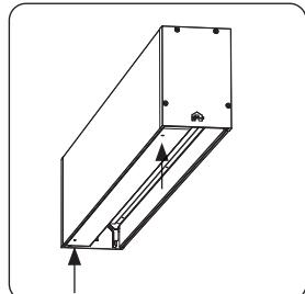
Klik de afneembare profielen van de kast terug toe en zet ze vast met een inbussleutel 2.5.
