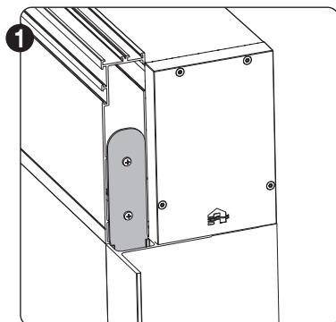
Pour garantir que le caisson de base M.W+ et le profil fixe de la coulisse M.WF+/M.WS+ sont parfaitement alignés et fixés l'un par rapport à l'autre, un support est fourni.
