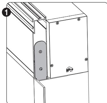
Om ervoor te zorgen dat het basis kastprofiel M.W+ en het vast profiel van de zijgeleider M.WF+/M.WS+ perfect t.o.v. elkaar gealigneerd en bevestigd zijn, is een beugel voorzien.
