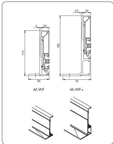
Er kan bevestigd worden over de volledige breedte van de flens via de daarvoor voorziene gaten. Deze flens kan, maar moet niet uitgelijnd zijn met het raamkader. Een correcte uitlijning met de kast, door gebruik van de montageschroeven, bepaalt de correcte positionering van de geleider en bij gevolg de schroefpositie.
