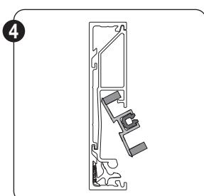
Draai het aluminium ritsgeleiderprofiel in het tussenprofiel en verzeker dat de mousse zich goed positioneert.
