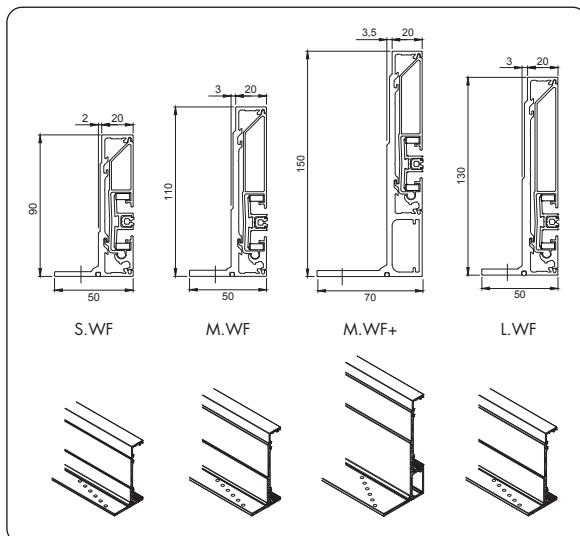
Er kan bevestigd worden over de volledige breedte van de flens via de daarvoor voorziene gaten. Deze flens kan, maar moet niet uitgelijnd zijn met het raamkader. Een correcte uitlijning met de kast, door gebruik van de montagestiften, bepaalt de correcte positionering van de geleider en bij gevolg de Schroefpositie.
