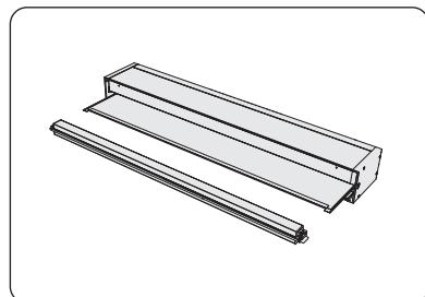
Le caisson est entièrement préassemblé afin de pouvoir le monter en 1 ensemble. La barre de charge est livrée séparément et est cliquée à la toile dans une phase ultérieure.
