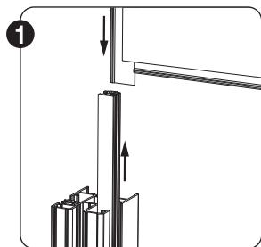
Schuif beide doekdelen in de aluminium ritsgeleider. Het is hierbij eenvoudiger om de ritsgeleider een stuk uit het tussenprofiel te gaan schuiven.
