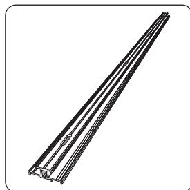
Cette coulisse de couplage est préperforée avec des trous (5 mm x 20 mm) tous les 250 mm. Tenez compte d'une distance maximale de 500 mm entre deux points de fixation.
