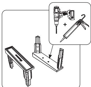
Deze diepe geleiders zijn voorzien van een aluminium voetplaat onder 0° of 5°. De voetplaten onder 5° zijn uitgerust met holte onderaan; welke met silicone opgespoten kan worden voor een extra waterdichting richting de spouw. Hiervoor zijn boorpunten voorzien, waardoor na doorboring de silicone kan ingespoten worden.
