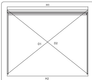
Au cours de cette étape, vérifiez toujours l'équerrage du système. Les diagonales (D1 et D2) et les parallèles (H1 et H2) doivent être absolument identiques pour le bon déroulement de la toile.
