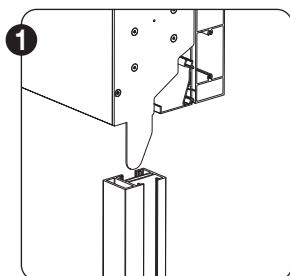
La coulisse d'accouplement autoportante C.F doit être glissée sur les goupilles du caisson.
