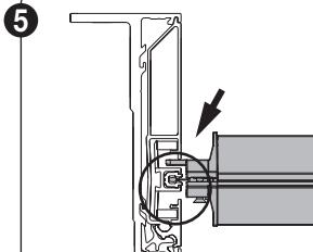
5 Indien de onderlat reeds voorgeassembleerd is, zorgt u ervoor dat de vinger van de onderlat zich correct positioneert ten opzichte van het aluminium ritsgeleiderprofiel.
