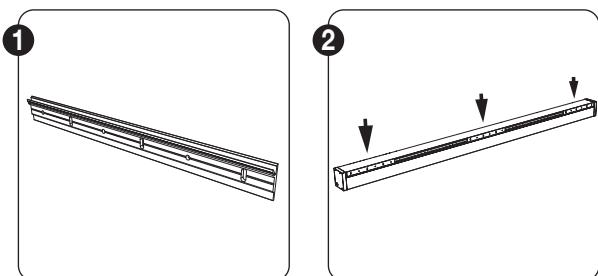
Le profil d'accrochage a une longueur de 300 mm et peut être fixé à la construction sous-jacente.
