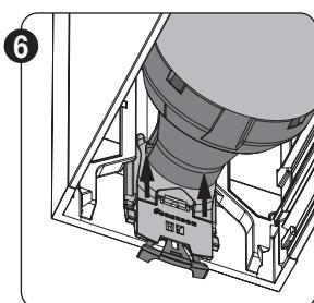
⑥ Tirez sur le tenon Click&Safe (la pièce bleue en PVC) vers l'arrière afin de glisser le système du tube d'enroulement dans le caisson.
