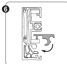
Positioneer het sluitprofiel loodrecht ( $90^\circ$ ) in de zijgeleider en klik deze dicht door druk uit te oefenen ter hoogte van de blauwe of zwarte clips. Deze hoek van  $90^\circ$  zorgt dat de mousse hierbij mooi recht blijft zitten.
