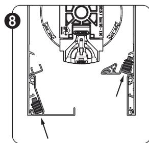
Klik de afneembare profielen van de kast terug en zet ze vast met een inbus-sleutel 2.5.
