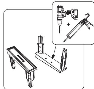
Deze diepe geleiders zijn voorzien van een aluminium voetplaat onder 0° of 5°. De voetplaten onder 5° zijn uitgerust met holte onderaan; welke met silicone opgespoten kan worden voor een extra waterdichting richting de spouw. Hiervoor zijn boorpunten voorzien, waارlangs na doorboring de silicone kan ingespoten worden.
