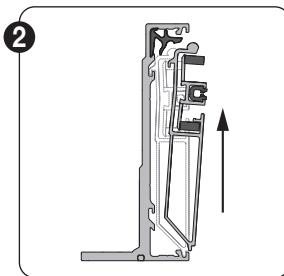
Détachez le profil intermédiaire de la coulisse en le faisant glisser. La coulisse est maintenant démontée.
