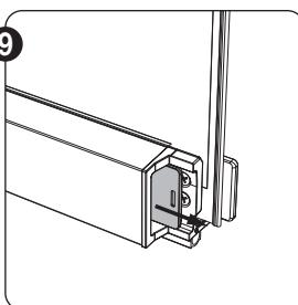
Sluit de vinger van de onderlatprop, deze positioneert zich voor de schroeven.
