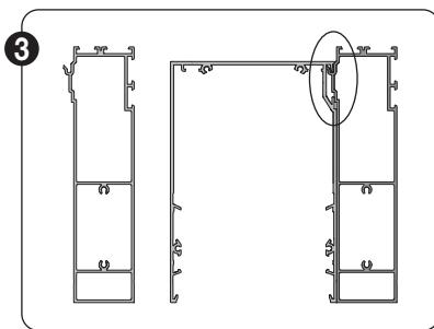
Ensuite, le caisson s'accroche sur le crochet prévu à cet effet. Tenez compte d'une hauteur supplémentaire de 10 mm du caisson de base M.W+ par rapport au caisson.
