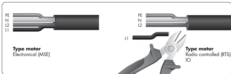
In geval van een IO home motor wordt de zwarteader afgeknipt (de zwarteader heeft geen functie bij dit type motoren).
