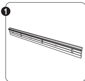
Het inhaakprofiel heeft een lengte van 300 mm en kan bevestigd worden aan de achterliggende constructie.
