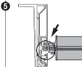
Si la barre de charge est déjà préassemblée, veillez à ce que les tiges de la barre de charge soient bien positionnées par rapport au guide pour fermeture éclair en aluminium.
