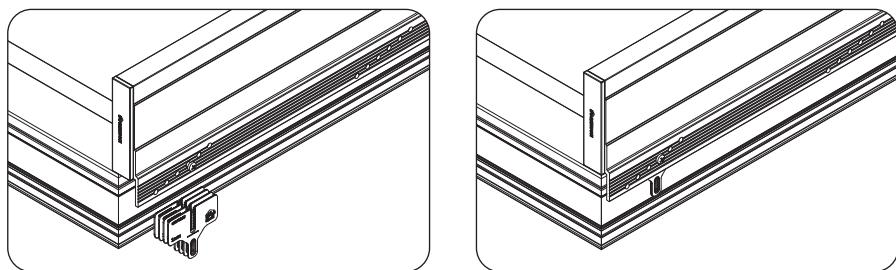
Schuif de afstandshouder over de schroef, tussen het raamkader en de geleider. Doe dit bij beide schroeven. Controleer de haaksheid en uitlijning van de screen t.o.v. het raamkader. Indien het aantal afstandshouders voldoet, kunnen de resterende schroeven aangebracht worden, met behulp van dezelfde hoeveelheid. Schroef nadien ook de bovenste en onderste schroef aan.
