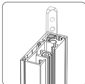
In de zijgeleider zit een montagestift voorgeassembleerd. Deze mag ingetrokken blijven tot wanneer de kast op de geleider geplaatst wordt.
