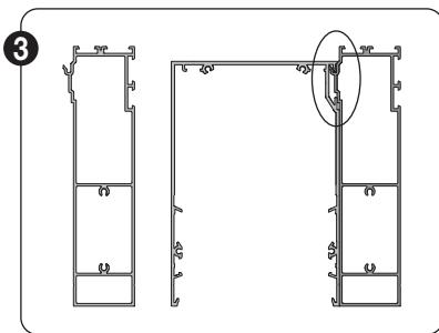
Hierna haakt de kast over de daarvoor voorziene haak. Hou rekening met een extra 10 mm hoogte van het basis kastprofiel ten opzichte van de kast.
