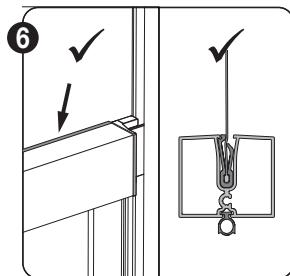
Assurez-vous que le clips soit positionné correctement dans la barre de charge.
