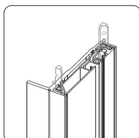
In de zijgeleider zitten montagestiften voorgeassembleerd. Deze mogen ingetrokken blijven tot wanneer de kast op de geleider geplaatst wordt.
