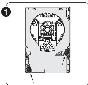
Schroef de afneembare profielen los met een inbus-sleutel 2.5.
