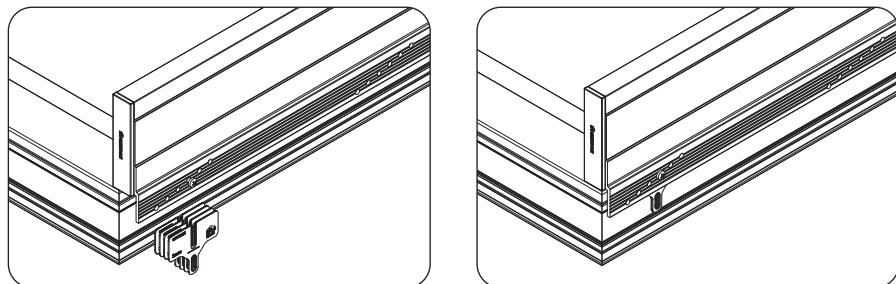
Schuif de afstandhouder over de schroef, tussen het raamkader en de geleider. Doe dit bij beide schroeven. Controleer de haaksheid en uitlijning van de screen t.o.v. het raamkader. Indien het aantal afstandshouders voldoet, kunnen de resterende schroeven aangebracht worden, met behulp van dezelfde hoeveelheid. Schroef nadien ook de bovenste en onderste schroef aan.
