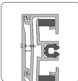
Gebruik schroeven met een maximale kophoogte van 2,5 mm om ervoor te zorgen dat de zijgeleider probleemloos zal toeklikken.
