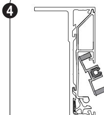
Introduisez le guide pour fermeture éclair en aluminium dans le profil intermédiaire en le tournant et assurez-vous que le caoutchouc cellululaire soit bien positionné.
