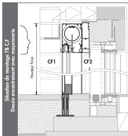
← Direction de (dé)montage du tube d'enroulement
