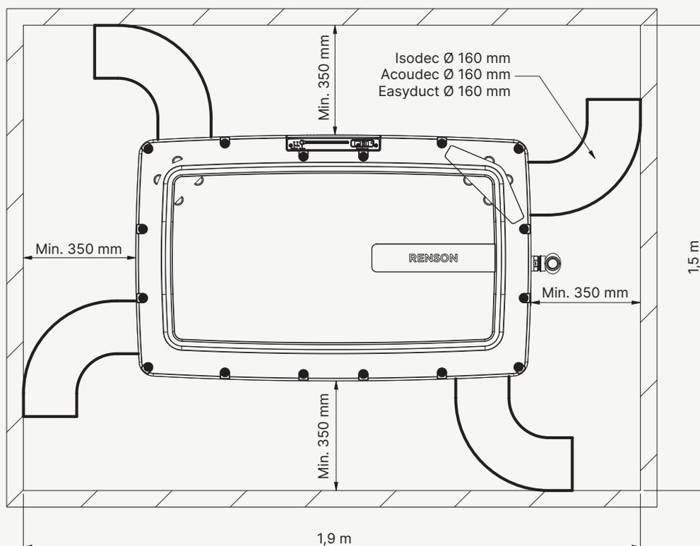
Vous trouverez ci-dessous quelques exemples d'installations dans la pratique, en tenant compte des distances minimales mentionnées ci-dessus et de la recommandation de Renson de toujours prévoir 1 m d'Acoudec Ø 160 mm du côté de l'impulsion et de l'extraction. Cela garantit une installation très silencieuse !
