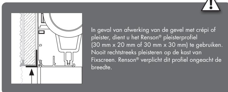
In geval van afwerking van de gevel met crépi of pleister, dient u het Renson® pleisterprofiel (30 mm x 20 mm of 30 mm x 30 mm) te gebruiken. Nooit rechtstreeks pleisteren op de kast van Fixscreen. Renson® verplicht dit profiel ongeacht de breedte.
